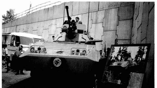
BMV사의 30밀리 대공장갑차량 새로 적외선 조준경을 장착했으며, M113 차체를 이용한다
