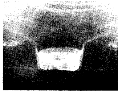
그림 3. Etchback process에 의한 W plug를 적용한 사진
