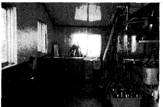
<사진 28> 파이프라인 기계실(좁은 공간에 요령 좋게 가설하여 이용하고 있으며 모든 표면을 방수처리하여 산유위생을 철저히 하고 있다)
