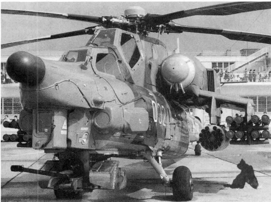
Mil 설계국은 1970년대 후반부터 기존 Mi-24/25와는 다른 새로운 헬기 설계안을 검토해 왔던 것으로 보이며, 1987년 말경에 그 모습을 나타낸 것이 Mi-28 Havoc(사진)과 Mi-34 Hermit이다. Havoc의 개발목표는 Mi-24나 Apache(美 공격헬기)와 같이 대전차 미사일 및 근접 지원 화력으로 무장하고, 주·야간 악천후 조건에서 작전이 가능하다
