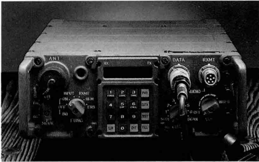
▲ECCM(對전자 방어책) 능력과 함께 데이터 전송이 가능한 PRC-999K FM 무전기 개인휴대 및 차량장착이 모두 가능하다
