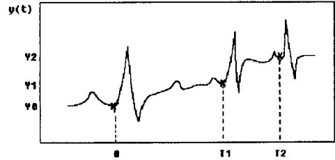
그림 3. 기저선이 동요된 심전도 신호 Fig. 3. ECG signal corrupted with baseline drift.
