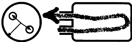
그림 2 반사형 소음기의 예와 좌표계 및 분석방법의 개념도
