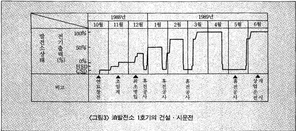
상승시켜 286℃ · 157kg/cm<sup>2</sup>로 했다. 여기서 원자로를 임계로 하기 전에 최종적인 확인을 한 후, 1988년 11월에 1차냉각계통의 붕소농도 희석 및 제어봉의 인출조작에 의해 泊원전 1호기는 초임계를 달성했다. 초임계 달성후 원자로의 물리적 특성이 설계대로 안전성을 갖고 있음을 확인하기 위한 시험 등을 수행했다.
