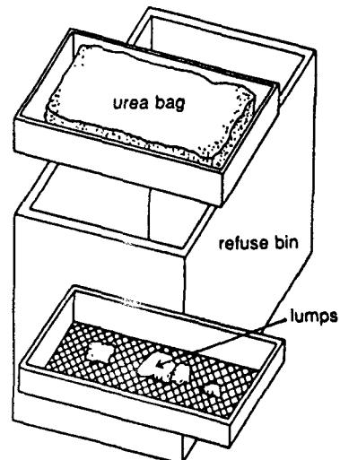
체위에 올려놓고 예리한 칼로 包袋의 양 끝을 가로질러 가르고 조심스럽게 包袋材를 빼내면 流動性 肥料粒子는 즉시 체를 통과하고 덩어리만 남게된다. 이 단계에서 체위에 남아있는 덩어리를 사진으로 남겨 놓으면 防止劑의 選定試驗에 도움이 되는 기록으로 利用할 수 있다. 寫眞에는 固結防止劑의 名稱, 添加量, 壓力(톤), 壓力を 加한 期間(주) 등이 記錄되어 있어야 한다.
