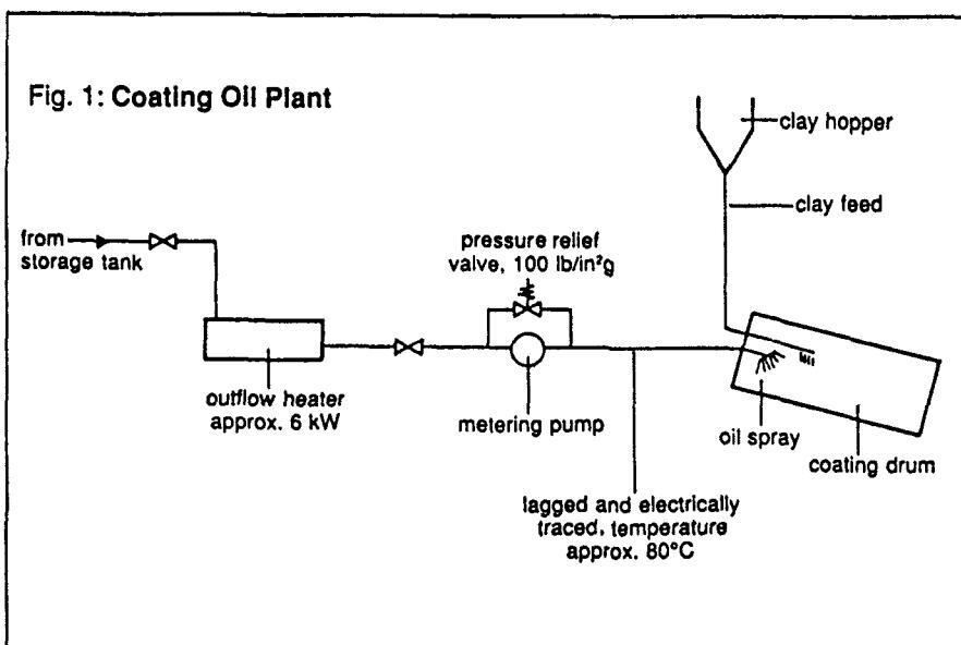
代表的被覆工程(固結 및 粉塵防止)은 Fig.1과 같다. 가장 效率的인 工程에서는 드럼을 回轉시켜 被覆劑가 肥料粒子위에 굴러떨어지게 하는 에너지를 供給한다. 被覆劑의 最適附着은 肥料粒子들은 相對的으로 一定하게 流動하게 하므로서 이루어진다.
