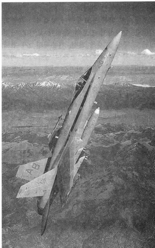
F/A-18 호넷 전투기는 주위, 경고, 위협에 대해 73종의 지시가 내려질수 있으며 각종 표시등이 59개나 되고, 17개의 다기능 스위치가 있다
