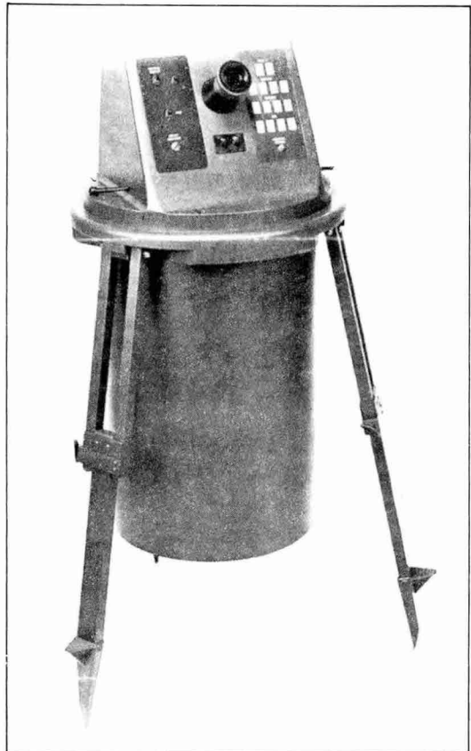
화학전에서 가스탐지 및 조기경보는 인원보호를 위해 필수적이다. 사진은 프랑스 Cilas Alcatel사가 개발한 원격 화학작용제 탐지기-Detadis이다. 이 장비는 가스가 레이저광을 흡수하는 현상을 이용한 것으로, 유기인제 성분의 유독가스를 탐지한다. 펄스 방식의 TES/CO 2 레이저가 사용되며, 3km 범위에서 60초이내에 경보를 발한다
