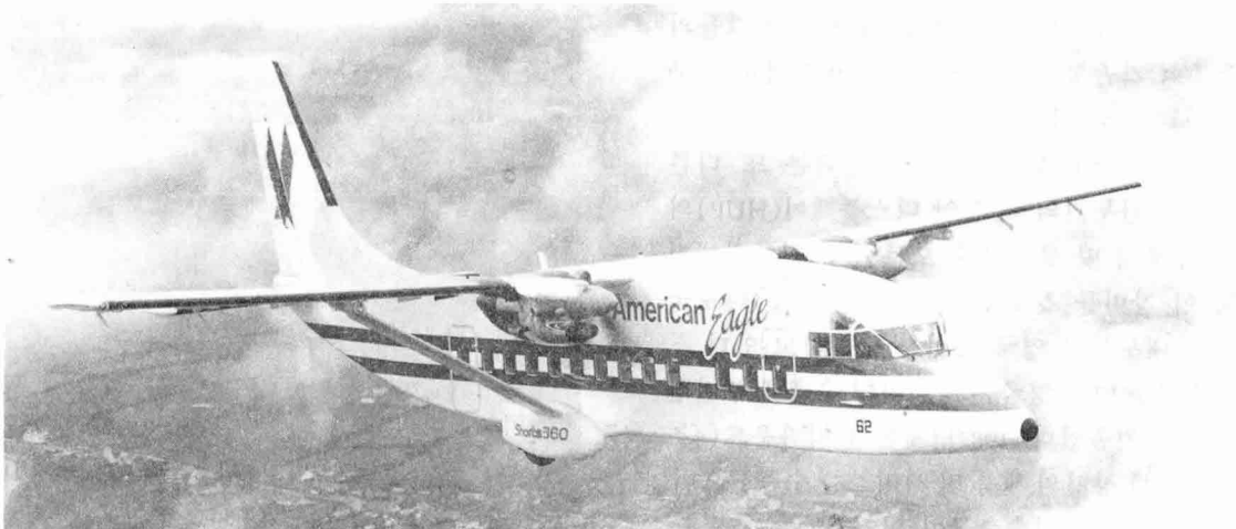
성공적인 쇼츠사의 360-300 컴퓨터작동 항공기. Pratt & Whitney PT6A-67R 터보프롭 엔진을 사용하며, 경제성이 탁월하다
