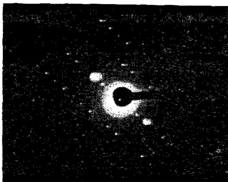
사진 5. 입계에 석출한 M_{23}(C,B)_6 의 전자선 회절 분석결과
