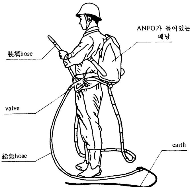
그림2 日本에서의 ANFO裝填機(一例)
