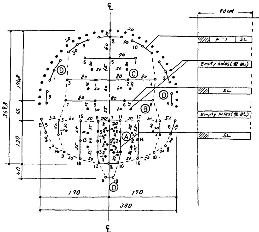
但, Cut holes 및 cut holes의 空孔은 Taper bit
