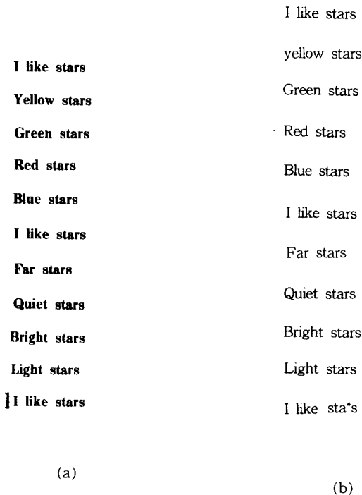
그림 12. 문자 인식 예 (a) 원 영상 (b) 인식 결과 Example of character recognition (a) Original image. (b) Result of recognition.
