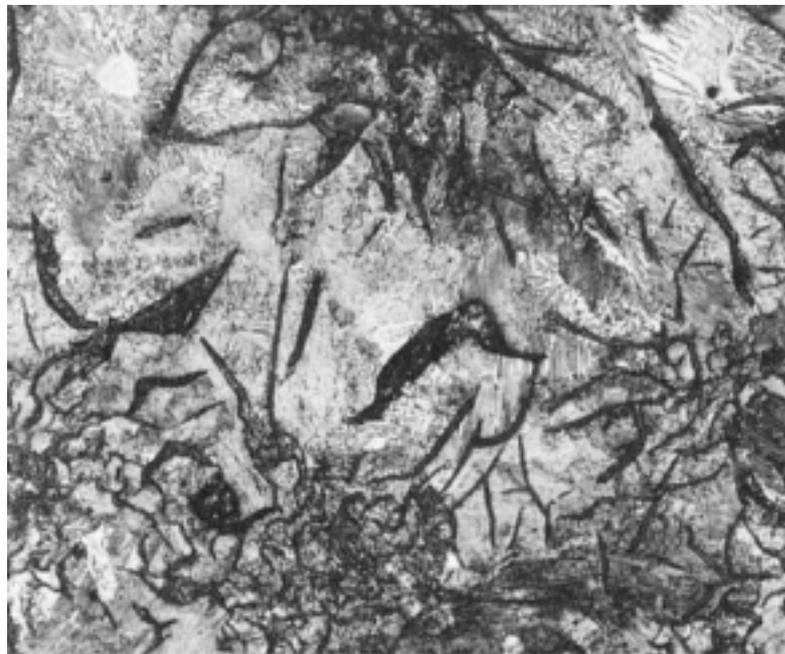
사진 4-B. 쇳방울의 腐蝕後 組織, 바탕의 직
