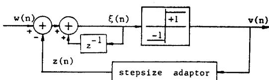
그림 6. DM 符號化形態의 출력을 위한 블럭
