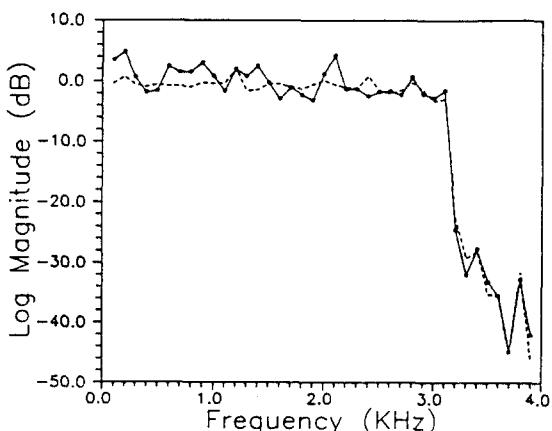
그림 9. DM 필터의 周波數應答 ( $f_c=3.2\text{KHz}$ , IIR, LPF)
