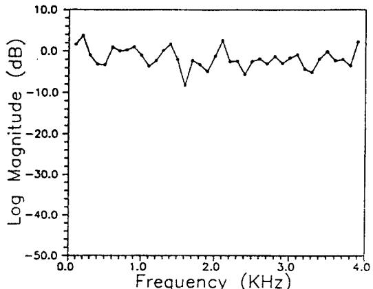
그림 7. 실험에 사용된 ADM 符號化特性( $f_s=32$  KHz)
