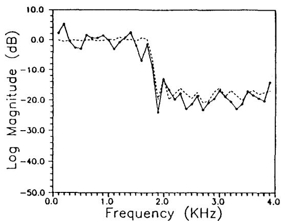
그림 10. DM 필터의 周波數應答 ( $f_c=1.8\text{KHz}$ , FIR, LPF)
