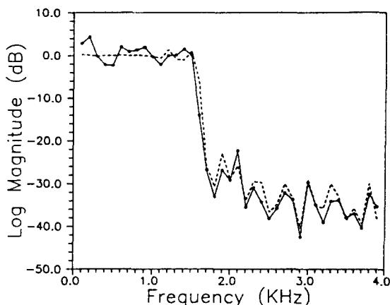
그림 8. DM 필터의 周波數應答 ( $f_c=1.6\text{KHz}$ , IIR, LPF)
