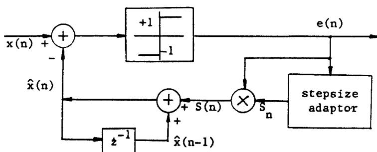
그림 1. DM 시스템의 블럭도
