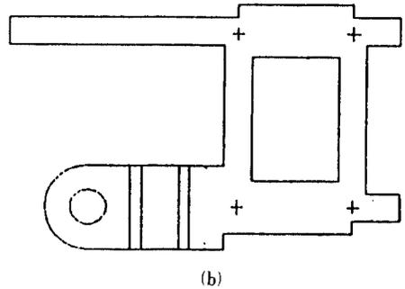
그림 5. 10-mils 사파이어 기판에 설계된 (a) 3-dB Lange Coupler와 (b) Branch Line 대역폭=17-23 GHz, 축적=1:20
