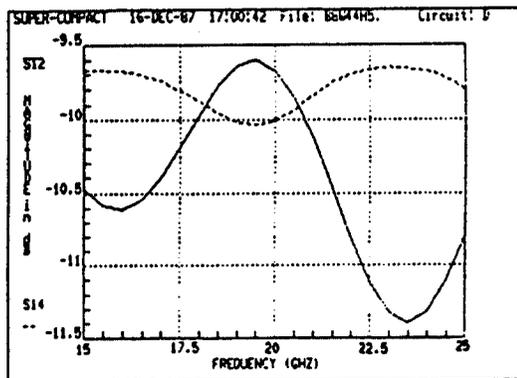
그림 10. Output Return Loss  $-10\text{dB}$ 를 갖는 경우의 3-stage 8-way Branch Line-Wilkinson Power Combiner의 s-파라미터.
