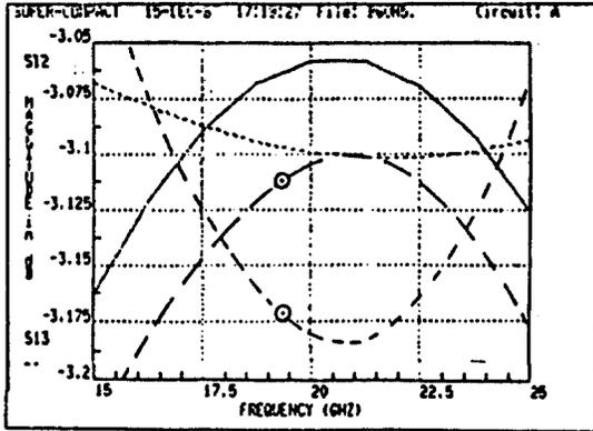
그림 6. Lange Coupler(⊙)와 Branch Line의 S-파라미터 (중심 주파수=20GHz)
