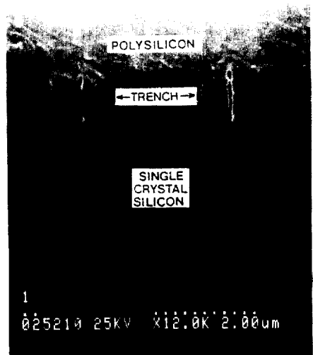
그림8. 충전재료가 내부에 채워지지 못하여 생긴 Trench 내부의 Void
