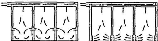
공장의 기둥에 설치한 유량 조절이 가능한 급기구 넓은 취출 면적을 갖고 있는 기둥에 설치한 급기구
