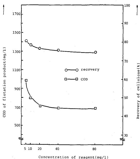
그림 9: 시약량의 부상결과에 미치는 영향(pH : 5.8, rpm : 1200)
