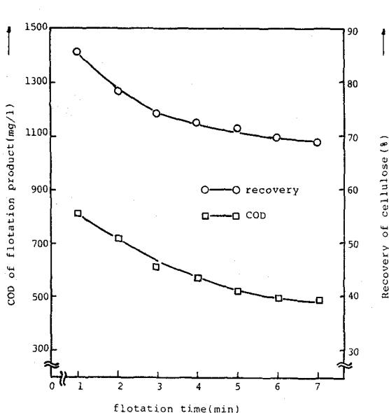
그림 12: 부상시간에 따른 부상실험의 결과 (pH : 5, 시약량 : 20mg/l)
