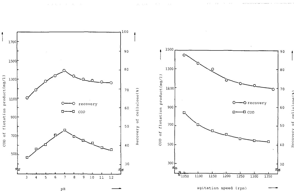
에 있어서 전제적으로 산성액상에 서 더욱 유리한 경향을 나타냈는데 폐수의 산성화는 주로 사용된 응집제 황산반토의 영향이다.<sup>7)</sup> 이의 사용량에 따라 pH의 범위는 실질적으로 5~7범위에 있을 것으로 판단되는데 pH 5 이하의 작업은 실질적으로 어려우므로 본 실험에서 결과를 위한 가장 적합한 조건은 pH 5라고 본다. 이 때의 섬유 회수율은 74% 그리고 COD값은 610mg/l에 달하였다.
