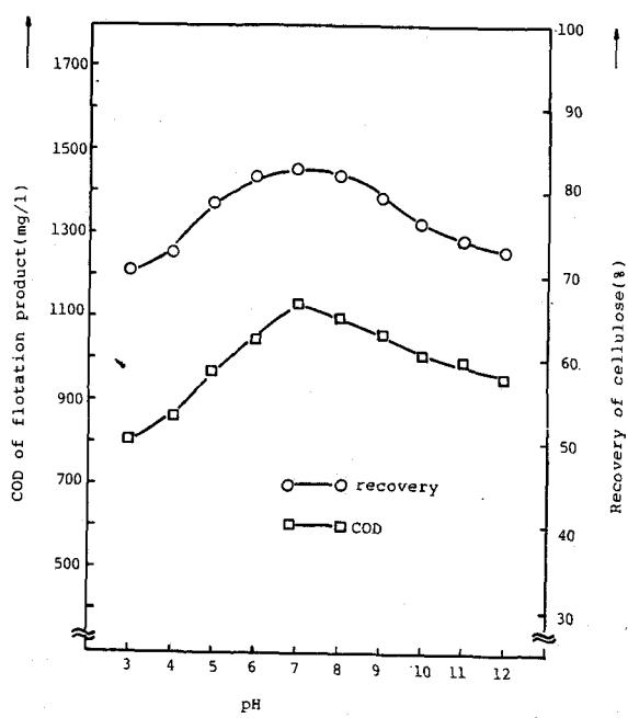
그림 8: 원폐수의 pH에 따른 부상실험 결과(부상시간 : 3min, rpm : 1200)
