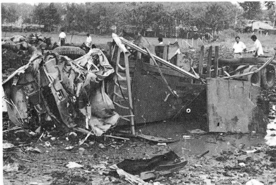
〈사진3〉폭발압으로 탱크차의 운전석(화물차 뒷쪽)과 화물차는 넘어지고 탱크차의 탱크만이 날아갔다.
