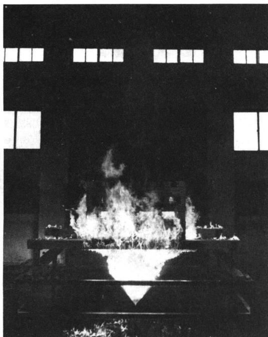
이와같은 방법으로 시험용 목재크립을 강제연소시키면서 헤드로부터 물을 방사하여 시험중의 천정부온도 및 시험후의 목재크립 중량감소량에 따른 시험용헤드의 소화능력을 시험함
