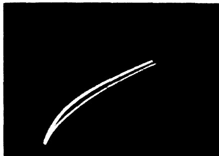
그림 5. 드레인 전류-전압 특성 Fig. 5. The characteristics of drain current-voltage (InSb; 1,500Å, L; 80μm, W; 2mm, SiO 2 ; 1,000Å).
