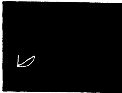
그림 4. 인가 전압 1000V (a) 인가 전압(A) 과 광 출력의 세기(B) (b) V-I (Intensity) 특성 곡선 Fig. 4. Applied voltages : 1000V (a) Applied voltages(A) and laser intensity(B) (b) V-I (Intensity) characteristic curve
