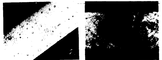
그림 9. 투과 광량의 변화 편광기와 시편의 광축이 a)45° b)0° Fig. 9. Variations of light transmittance. Optical axis of polarizer and specimen is a)45° b)0°
