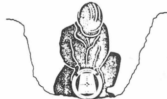
배관공은 방사되는 레이저빔을 받아서 빔이 표적의 중심에 위치하도록 관의 위치를 조정
