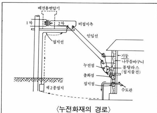
위의 그림은 인입선 비접지측이 함석판에 접촉누전, 몰탈라스와 수도관을 타고 지면으로 통하는 누전경로를 나타낸다. 이때 몰탈라스 부분이 발열되면서 목재부분에 착화, 화재가 발생한 누전경로를 표시한 예이다.
