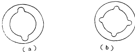
그림 3 變形을 가져오는 斷面과 그 修正形
