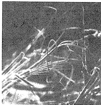
[그림 8] 케블라 타이어코드 (1500 d/2)의 DeMattia type 疲勞試驗후 切斷된 곳의 케블라 필라멘트의 Fibril 化
