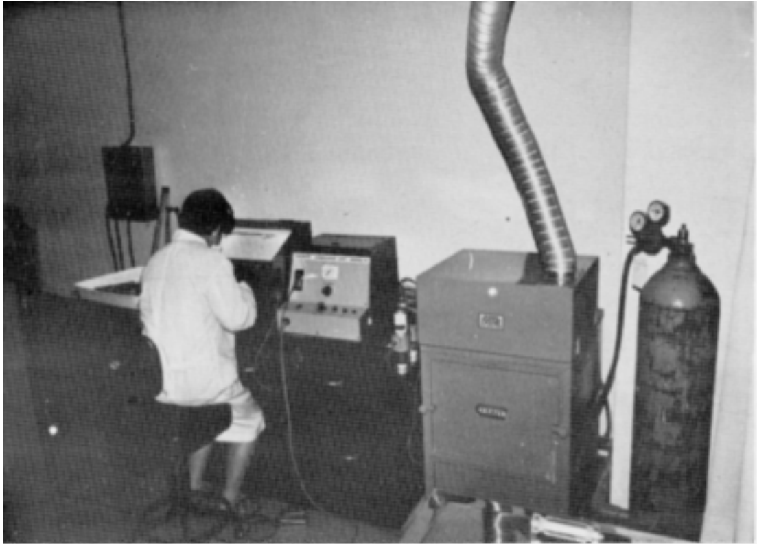
〈사진 3〉 AIR BRASIVE 에 의한 녹제거 작업
