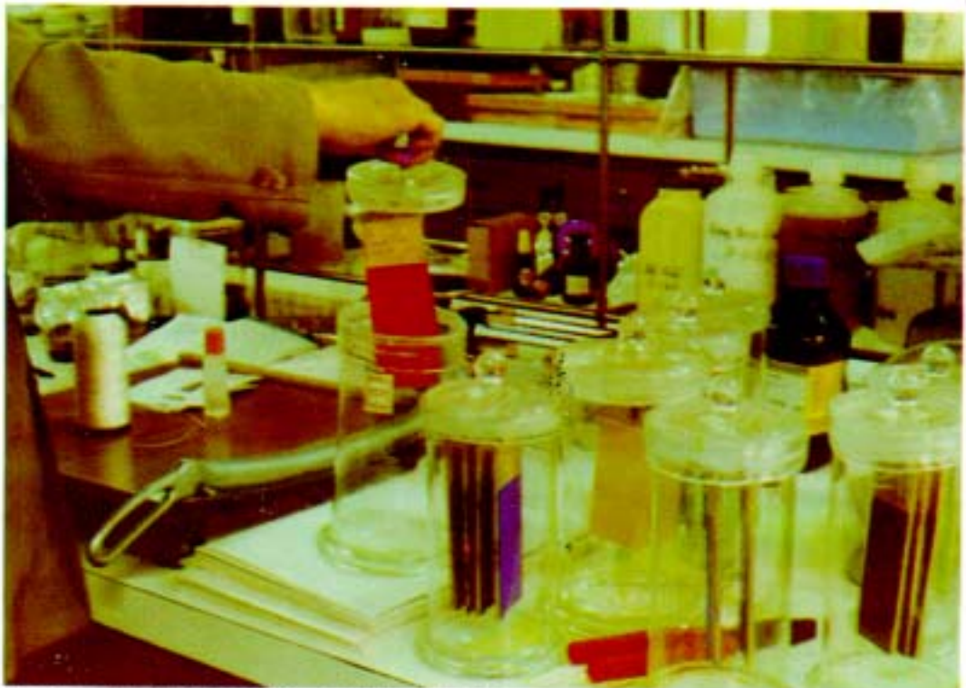
사진 1 : 耐公密性 試驗을 위하여 아황산가스( \text{SO}_2 )와 약간의 물을 표본병에 넣고 파라핀 왁스로 밀폐시키는 狀態
