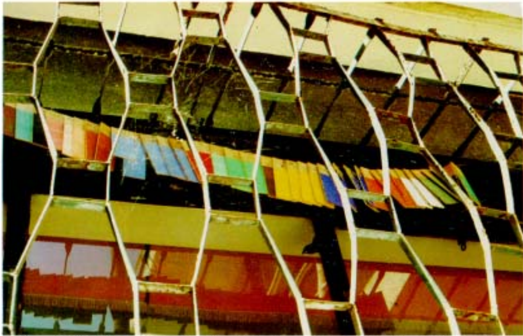
사진 3 : 自然環境 試驗을 위하여 化學, 木材試驗室 창문밖에 배달아 自然環境에 노출시켜 놓은 狀態
