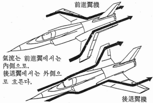
〈그림 3〉 翼型에 의한 氣流의 흐름의 差異
