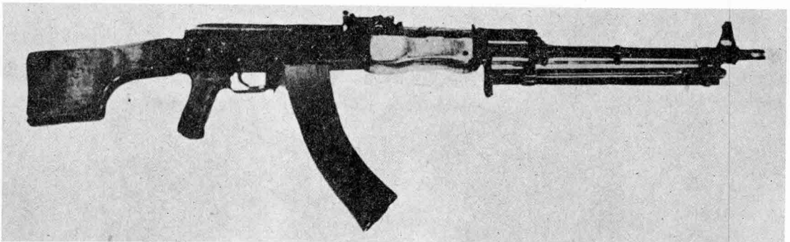
소聯의 5.45mm RPK-74 輕機關銃은 단지 兩脚台가 설치된 小銃에 불과하며 처음에 기대한 만큼 7.62mm 機關銃을 代替할 것으로 보이지는 않는다.
