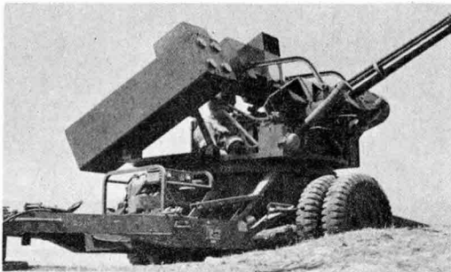
〈그림 5〉 GE에서 개발한 4대의 Stinger를 반사하는 발사대를 갖춘 개량된 Vulcan 對空시스템 PIVADS/Stinger Hybrid
