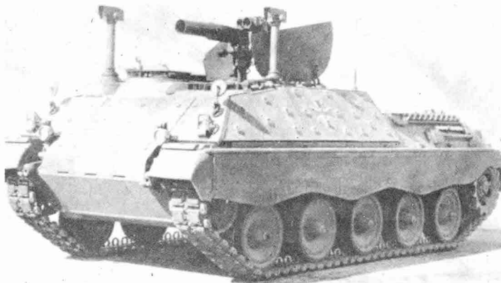
油壓式으로 작동되는 ARGM HOT용의 發射臺를 갖춘 Jaguar 戰車 destroyer는 統合防衛體系의 重要한 요소이다.
