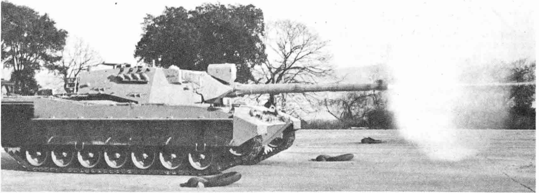
시험發射하고 있는 OF 40. OTO 105/52mm砲는 APFSDS彈을 포함한 L7/M68 105/51mm 砲에 사용되는 모든 彈을 다 發射할 수 있다.
