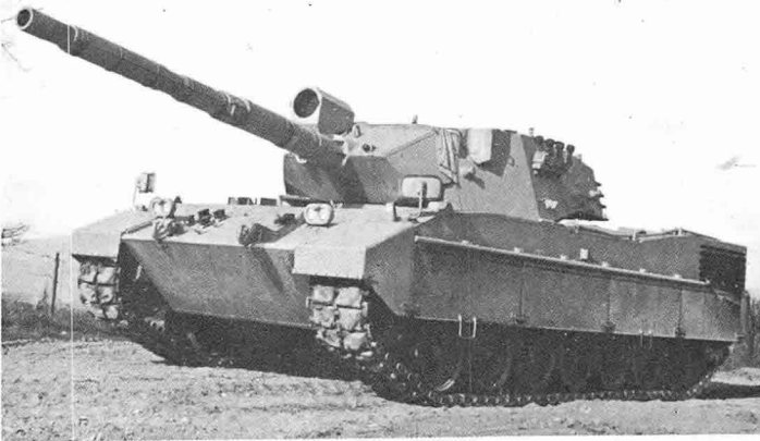
FIAR 과 비슷한 AEG-Telefunken PZB 200 LLL TV카메라가 장치된 MK2 OTO Melara OF40 MBT. 立體式 距離測定器를 사용하기 위해 만들어진 돌출부는 레이저距離測定器도 바뀔때 따라 不必要하게 되어 MK2 계열生産에는 제외된다.
