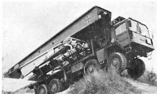
을 부분을 밟침다리로 하여 Two-field 橋梁으로 이용할 수 있는 이태리에서製作된 全長 22m 橋梁이 M-48 戰車體와 같이 사용되나 美陸軍에서 M-48 車體가 M-60으로交替되어 왔다.
