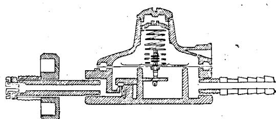
은 下向으로 구부려져서 벨브막대를 밀어올린다. 이때 지렛대의 원리에 의해서他端에 붙어 있는 벨브사이드가 아래로 움직여서 노즐出口를 좁혀서 가스量을減少시킨다. 다이아프램은 위쪽에서 스프링으로 눌리어서 가스壓과 스프링強度가 맞먹는 곳에서 노즐의 用度가 定해져서 流出가스壓이 決定된다.
