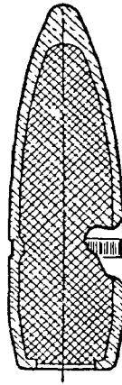
〈그림 3〉 XM777탄의 탄자(좌)와 M193보통탄의 탄자구조 (모든 외형 치수 동일)
