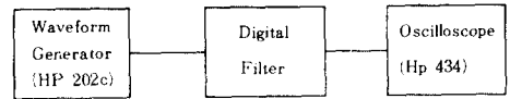
그림 6. 디지털 필터의 실험장치 Fig.6. Test set up for measuring characteristic of digital filter.
