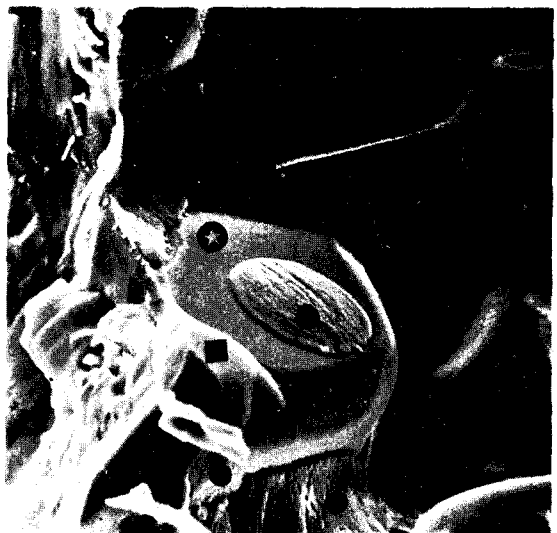
<그림-3> energy dispersive X-線 分析에 의해서 確認된 크링카 內的 알카리 黃酸塩; 원으로表示한 粒子는 K와 S 含有, 四角으로表示한 粒子는 K, S 및 Na 含有, 별표 粒子는 Ca와 Si 含有
