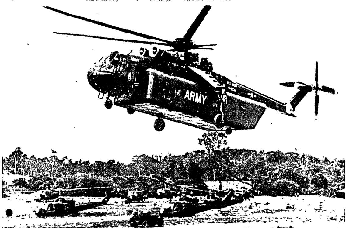
大型貨物車 貨物간(베인)을 脊體밑에 連結해서 飛行하는 CH-54
