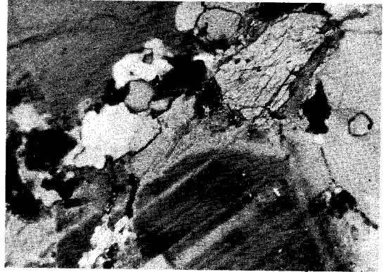
사진 4. 反復 累帶構造를 보이는 斜長石 : 格子狀 雙晶을 보이는 미사장석 사이에 이들의 경계부를 뚫고 들어온 石英이 圓粒 또는 불규칙한 形態로 자리잡고 있다. 그리고 底面을 보이는 角閃石도 보인다.(5×10 cross nicol)
