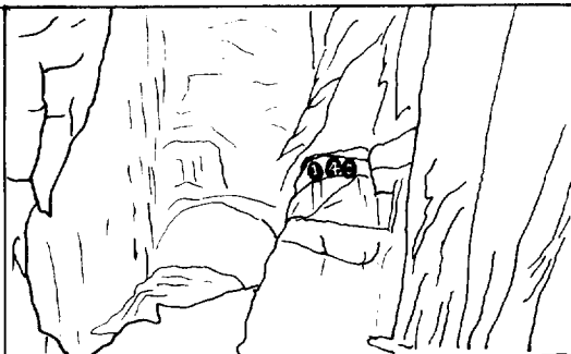
그림 3. 露頭 14 ( N70^{\circ}E \cdot 80^{\circ}SE, N30^{\circ}W \cdot 70^{\circ}SW, N20^{\circ}W \cdot 78^{\circ}NE )
