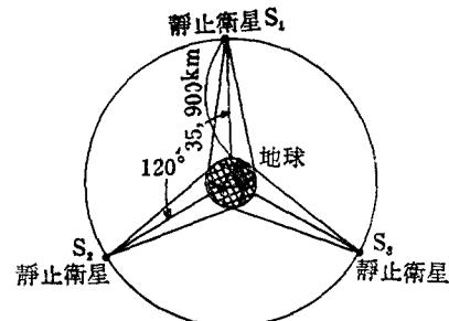
그림 1. 靜止衛星에 依한 世界通信網
