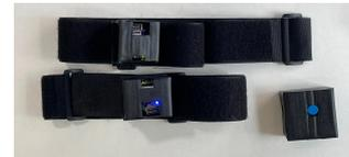
그림 2. 하드웨어 산출물(스위치, 기울기 센서1, 2)
