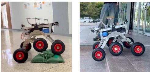
(그림 7) Robot Upper Weight Balance Test
