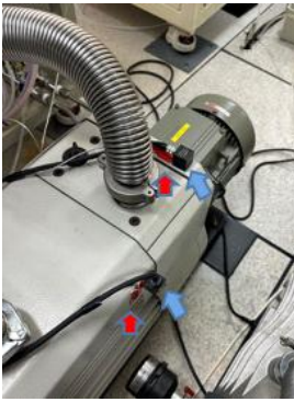
그림 1. 진동 센서 및 온도센서의 부착
